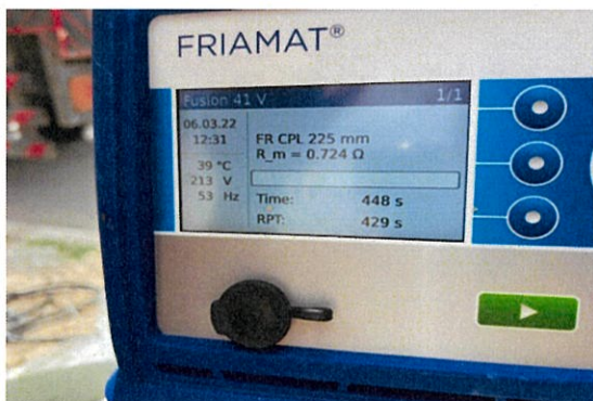
การเชื่อมต่อพลาสติก HDPE 26 มกราคม 2565 (Training on site)
